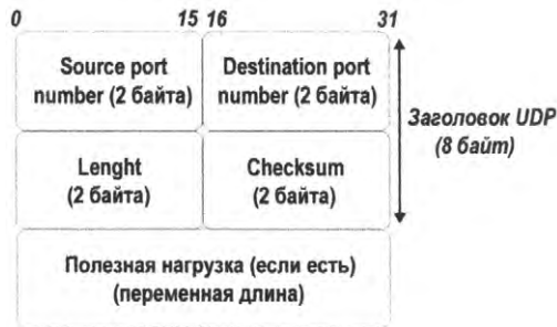
Рис. 1.10. Заголовок датаграммы протокола UDP
