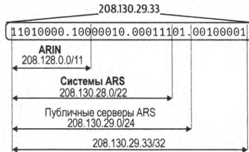
Рис. 1.14. Пример бесклассовой междоменной маршрутизации CIDR
