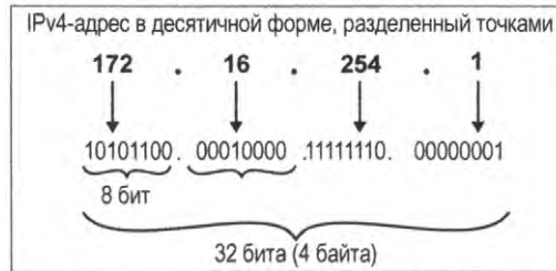
Рис. 1.12. Адрес в версии протокола IPv4
