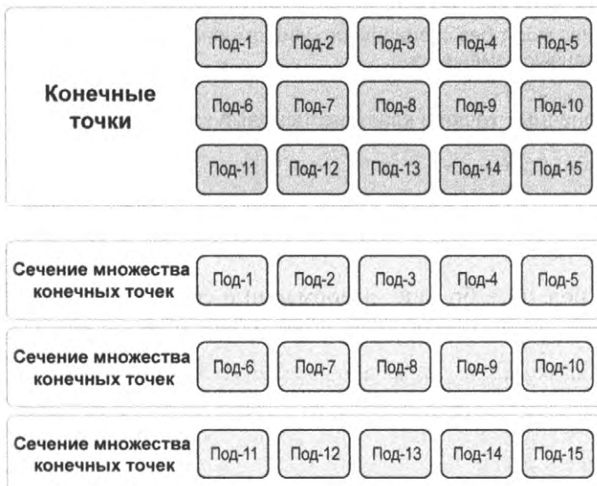
Рис. 5.2. Сравнение объектов Endpoints и EndpointSlice
