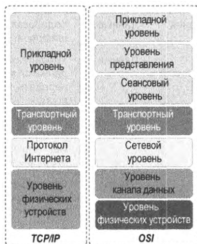
Рис. 1.3. Сравнение моделей OSI и TCP/IP
