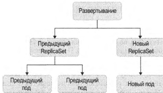
Рис. 4.1. Взаимосвязь между приложением Kubernetes Развертывание и подами
