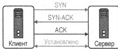
Рис. 1.6. Механизм тройного квитирования в протоколе TCP
