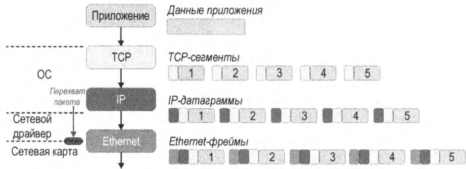
Рис. 1.8. Перехват пакета (packet capture) командой tcpdump
