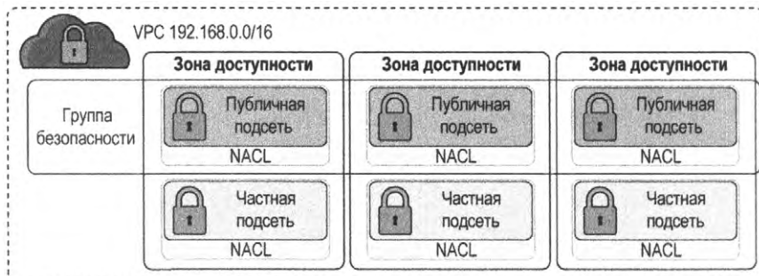
Рис. 6.6. Список контроля доступа к сети (NACL)
